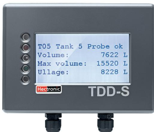
L'afficheur camion-citerne est assemblé derrière une vitre de manière à pouvoir être lu de l'extérieur. Il est fixé avec des bandes velcro. Le TDD-S est activé et l'illumination est mise en marche par un capteur de mouvement, qui fonctionne même à travers des vitrines métallisées et épaisses. Les données du contenu de la cuve sont transmises automatiquement par le contrôleur Mineo 2.
